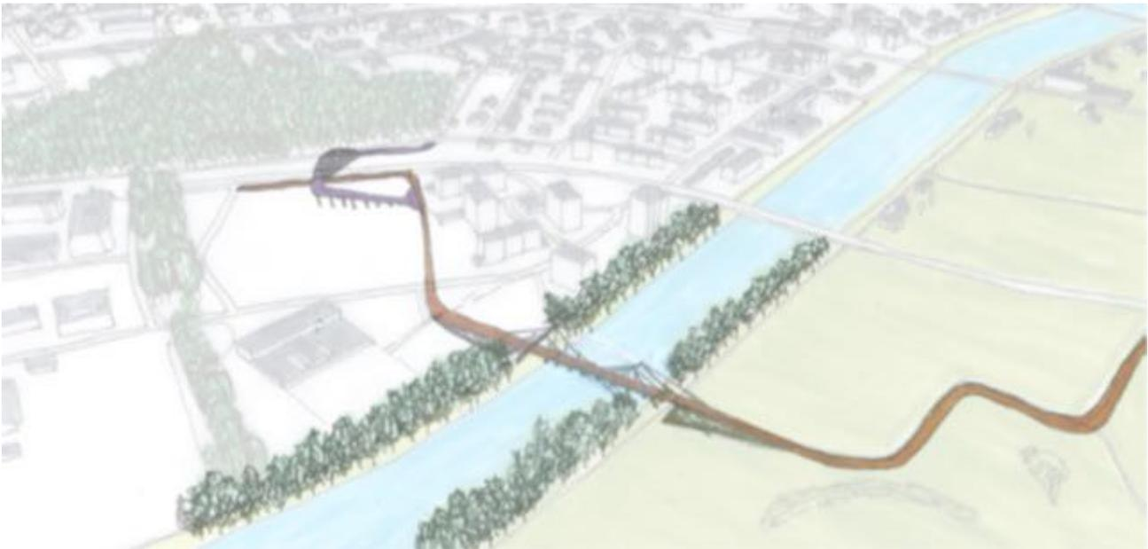
**Massnahmenbeschrieb** Bau einer ca. hundert Meter langen Brücke für den Fuss- und Veloverkehr über den Nidau-Büren-Kanal. Die Brücke ist Teil der Velobahn Biel - Lyss. Sie verbessert die Erreichbarkeit des Arbeitsschwerpunkts Brüggmoos mit dem neuen Regionalspital für den Veloverkehr und verbindet die Erholungsräume beidseits des Kanals.
