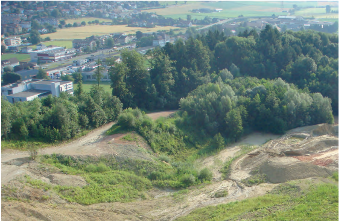
Fig. 5: La carrière d'argile Greuschenhubel à Perles. L'extraction a lieu sur plusieurs hauteurs en même temps, de manière à obtenir un bon mélange d'argile.
