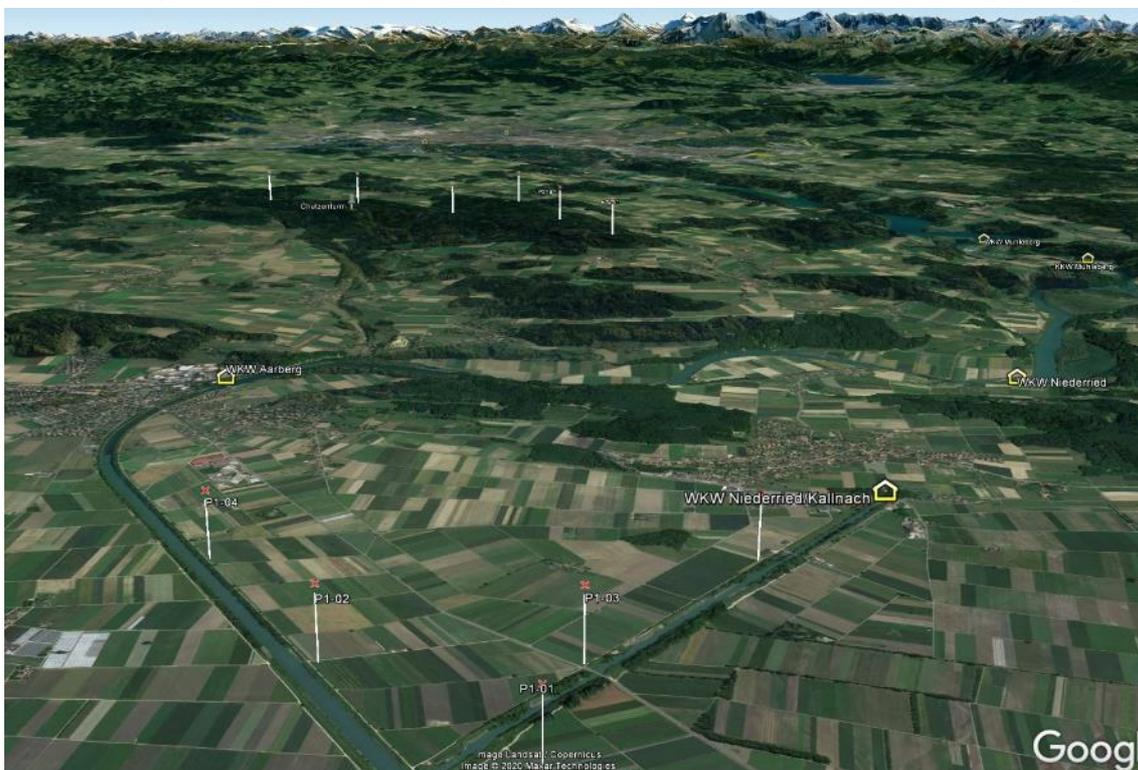
Die potenziellen WEA wurden im Google-Earth mit einer Höhe von 250 m definiert und mit einer Linie an die Bodenoberfläche verbunden.
