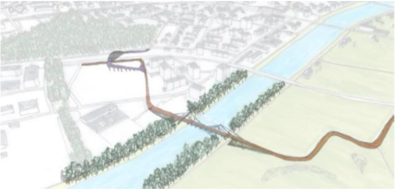
**Massnahmenbeschrieb** Bau einer ca. hundert Meter langen Brücke für den Fuss- und Veloverkehr über den Nidau-Büren-Kanal. Die Brücke verbindet das Spitalareal mit den regionalen Velorouten entlang dem Nidau-Büren-Kanal und in Richtung Aegerten und Lyss und verbindet die Erholungsräume beidseits des Kanals.
