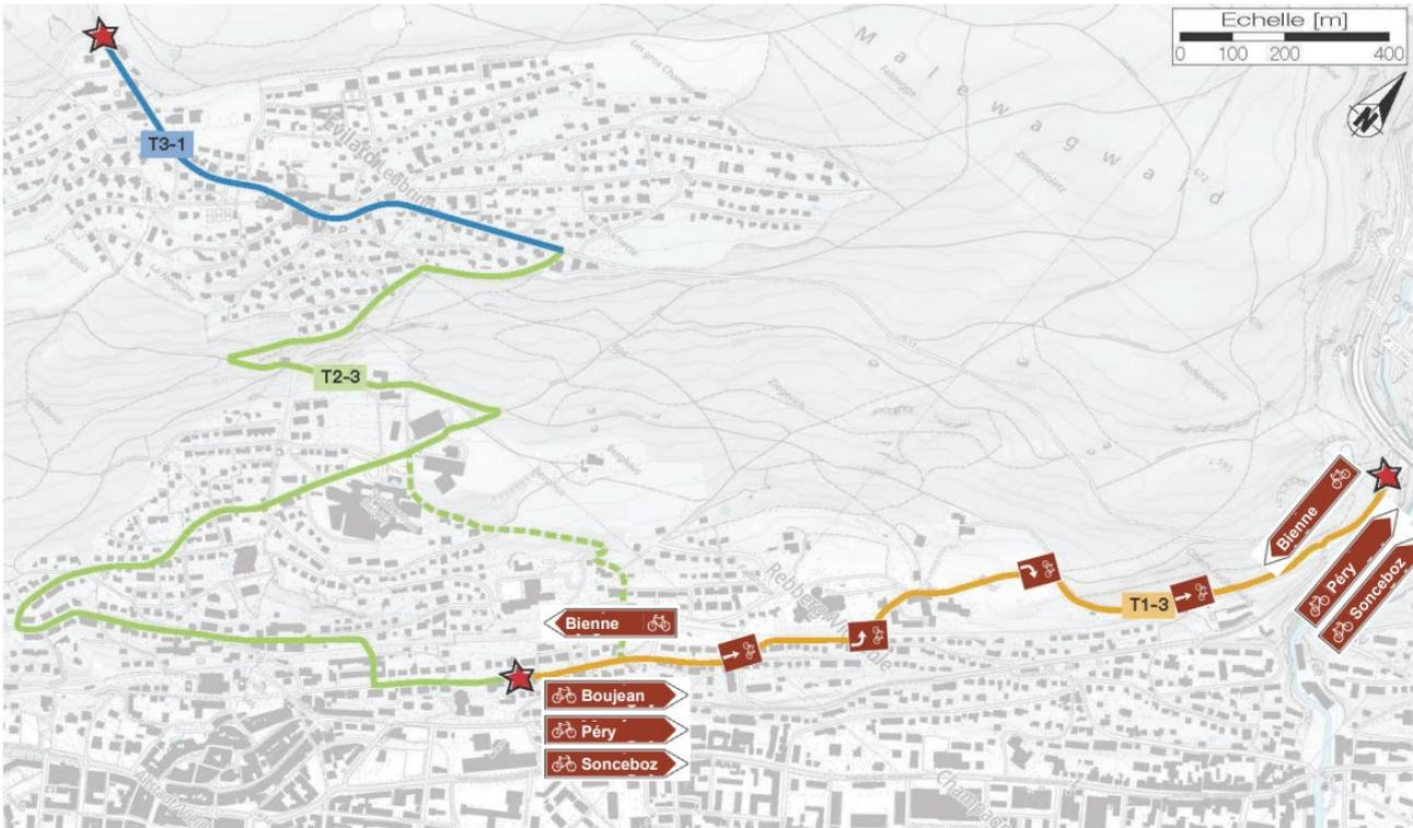
**Massnahmenbeschrieb** Verbesserung der Bedingungen für den Veloverkehr und Verbesserung der Verkehrssicherheit. Prinzip: Verkehrsberuhigung in den Quartieren mit Umsetzung einer Tempo-30-Zone; Gestaltung eines kombinierten Fuss- und Velowegs sowie von Radstreifen bergwärts; Fuss-/Radweg im Wald ohne Verkehr; Signalisierung Veloverkehr
