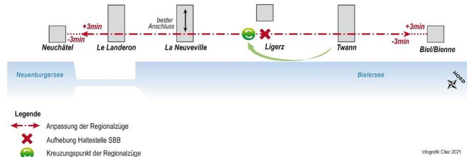
**Abbildung 15 – Anpassung des Fahrplans des SBB-Regio, um den Kreuzungspunkt Richtung La Neuveville zu verschieben**
