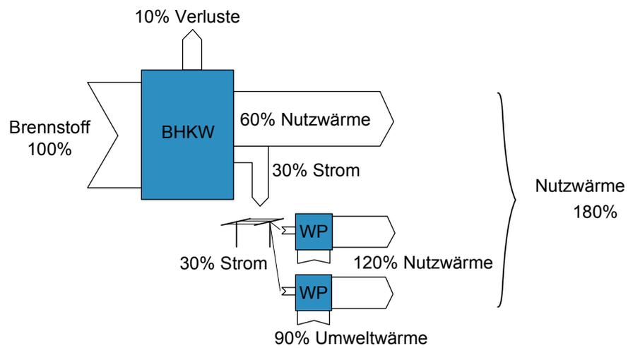
Abb. 12: Prinzipskizze und Nutzungsgrad einer wärmegeführten WKK-Anlage
