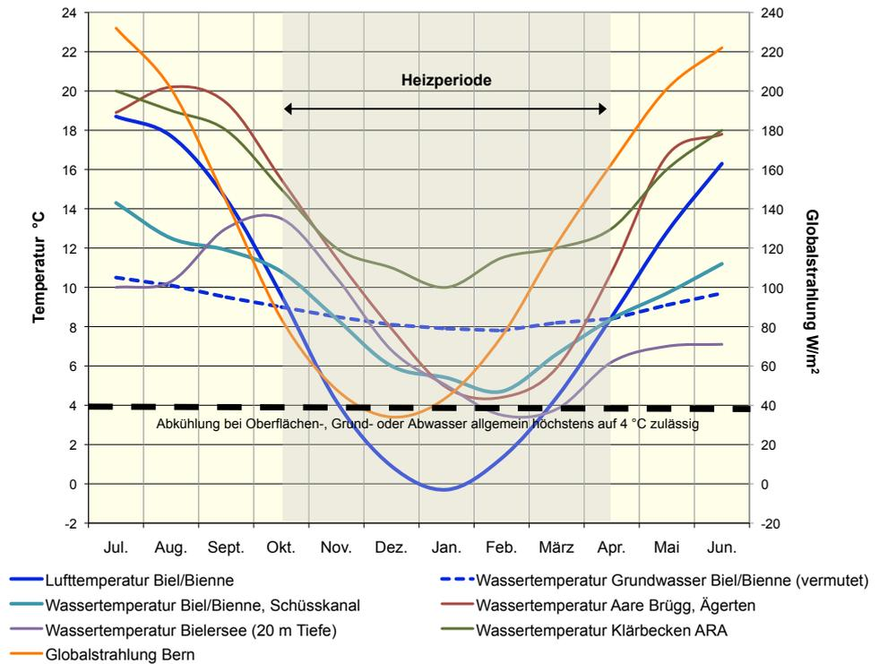
Abb. 9: Temperaturverlauf und Globalstrahlung verfügbarer Umweltwärmequellen<sup>33</sup>
