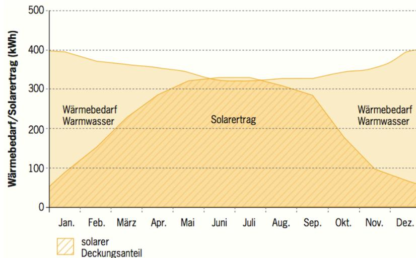
Abb. 11: Monatlicher Wärmebedarf zur Warmwasserbereitung für einen 5-Personenhaushalt und Solarertrag von 5 m<sup>2</sup> Flachkollektoren im Jahresverlauf<sup>38</sup>
